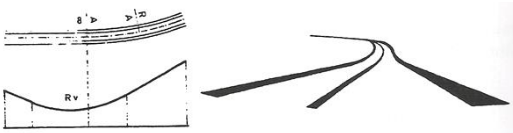
figura 1.108. Início de curva circular após uma concordância côncava, provocando uma quebra do traçado
