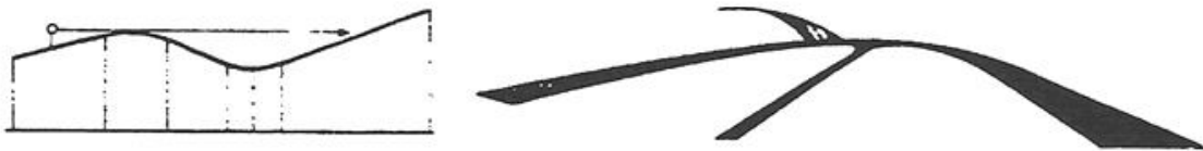
figura 1.106. Mau traçado em perfil (perda do traçado)
