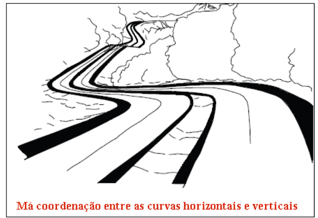
figura 1.101. Coordenação do traçado em planta e em perfil longitudinal
