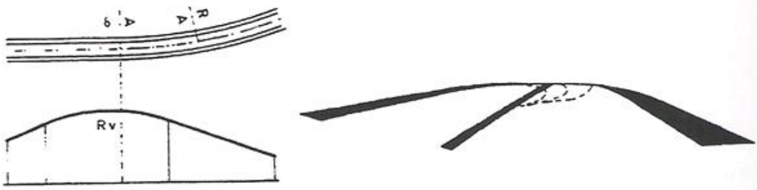
figura 1.107. Início da curva circular após concordância convexa, o que impede ver a mudança de direcção em planta
