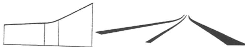
figura 1.103. Mau traçado em perfil (concordância diminuta)
