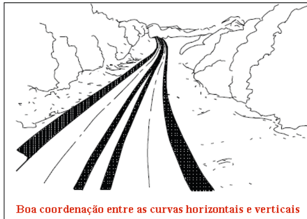
figura 1.101. Coordenação do traçado em planta e em perfil longitudinal
