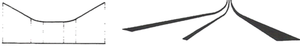
figura 1.105. Mau traçado em perfil (pequeno trainel entre duas concordâncias côncavas)
